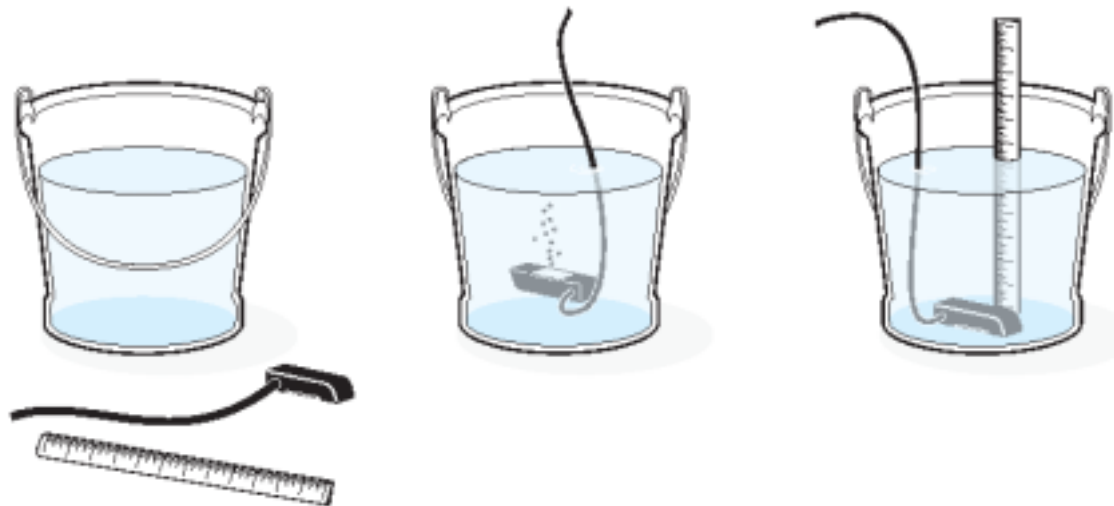
图 18 校准浸入式面积/速率传感器
